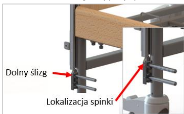
Montaż dolnego ślizgu
