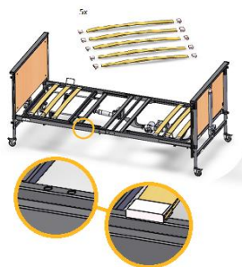
Montaż lamel drewnianych
