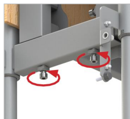
Dolne śruby dociskowe na adapterze transportowym
